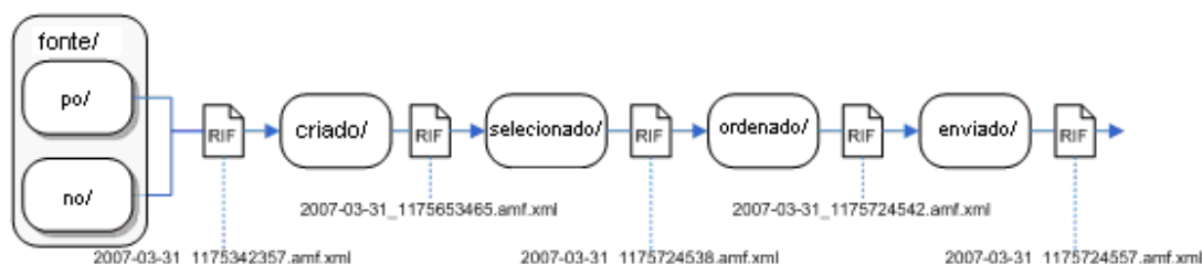
Figura 10 – Representação do armazenamento da cópia do RIF em cada estágio do processo do NEP Fonte: Krichel e Sillari (2007)
